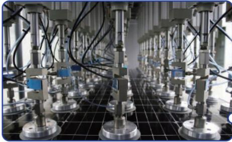
Ensayo de carga mecánica
