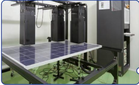
Ensayo de resistencia a los puntos calientes
